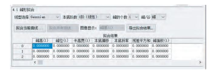
高级功能:应力拟合:针对Si、GaN、SiC等多种材料,从拉曼光谱中解析材料的应力变化,直接获得应力定量数值,并可根据校正数据进行校正。
